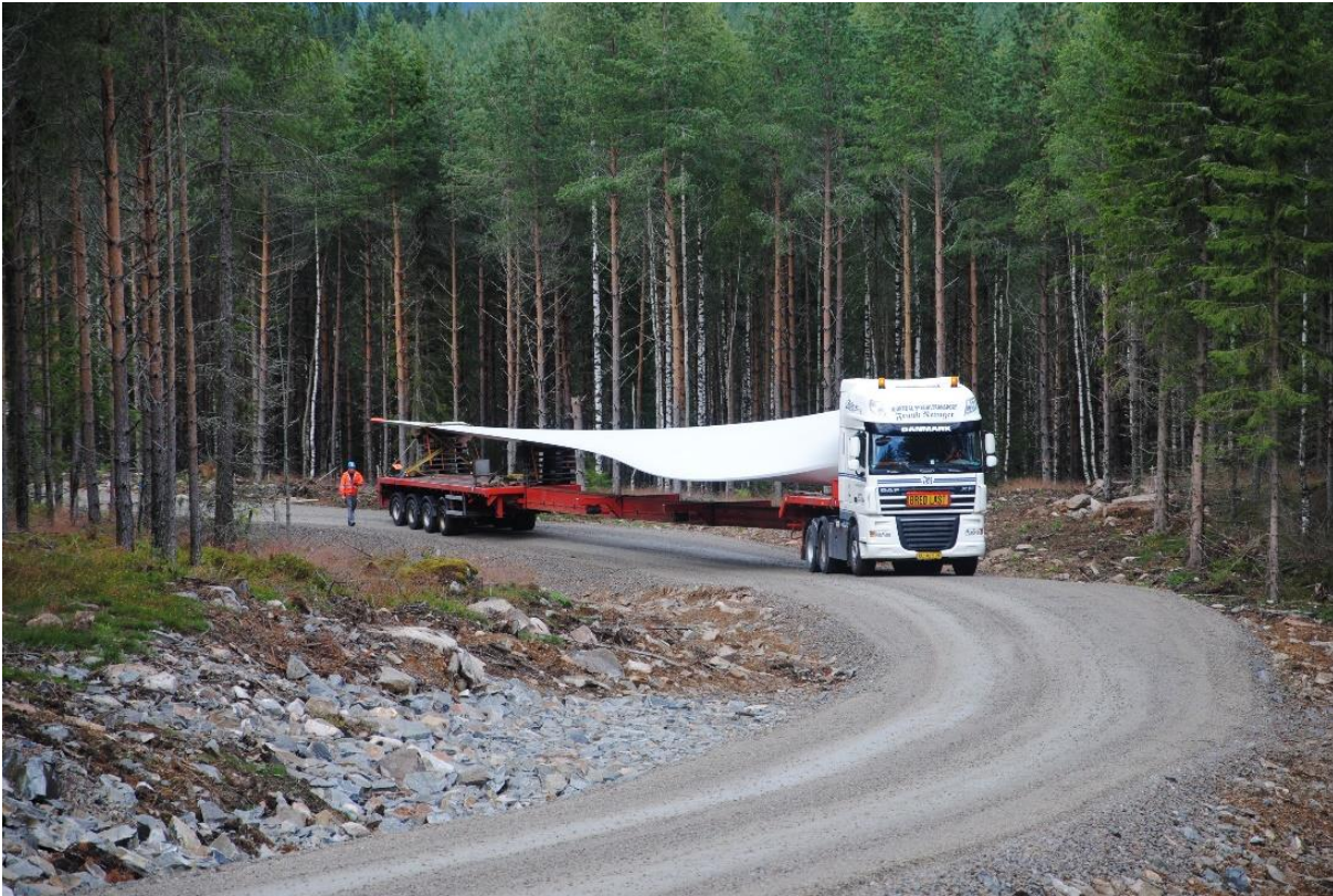
Figur 10. Transport av rotorblad. Foto: Erik Aretorn.
